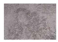
「ふるい下残さ」とは 建設混合廃棄物の選別処理において生じる 残さで、概ね10mmアンダーのふるい目を通 過した土砂混じりのもの。安定型廃棄物とし て取り扱えない管理型混合廃棄物。
