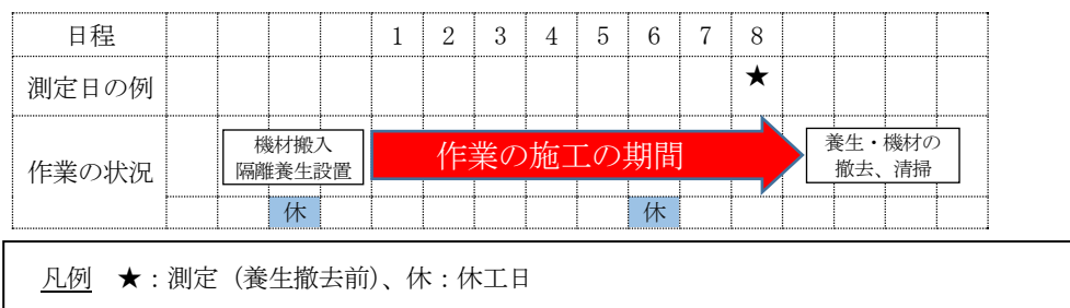
図29 負圧隔離養生内の石綿粉じんが飛散するおそれがないことを確認するタイミング
