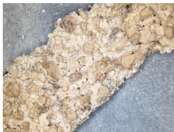
図5 ひる石吹付け材近影
