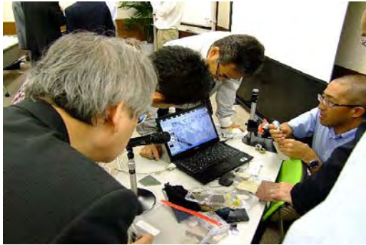
USB 顕微鏡を使い石綿の繊維束があるか調べる
