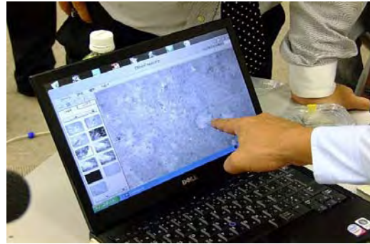
USB 顕微鏡を使い石綿の繊維束があるか調べる
